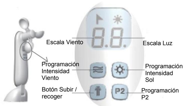
Si el sensor recoge en lugar de extender el toldo, entonces debe reprogramarse el mando ED01, invirtiendo el sentido de giro y volver a sincronizar el sensor.
